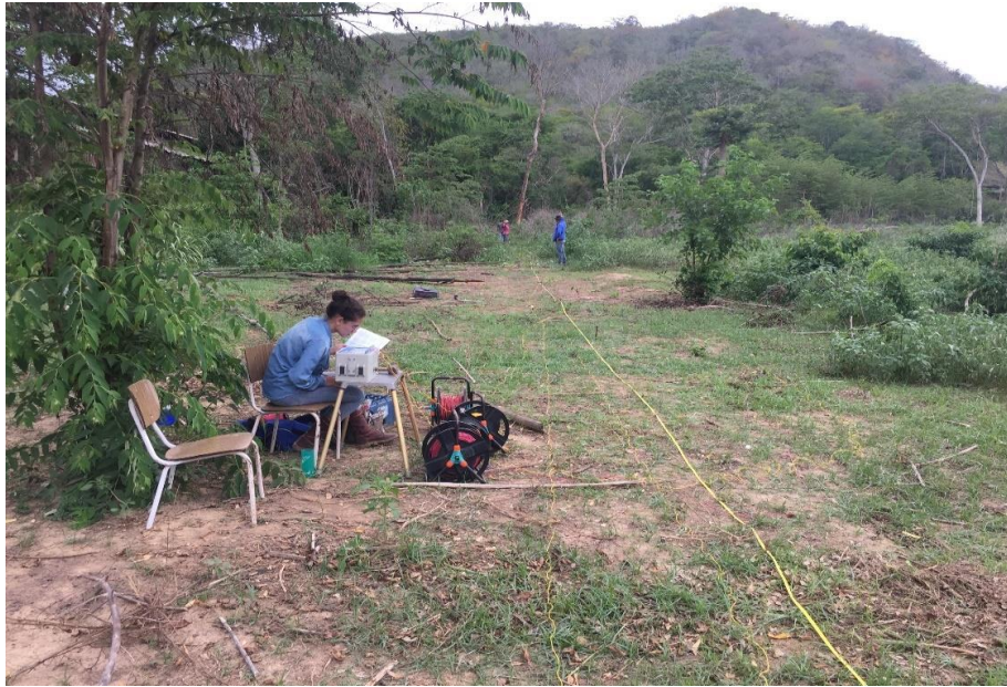
Figura 1. Adquisición Tomografía d Resistividad Eléctrica
